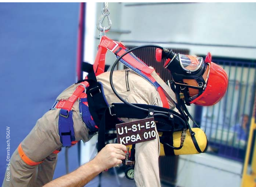
Absturzversuch mit einem Personendummy zur Bestimmung der Sicherheit von kombinierten Persönlichen Schutzausrüstungen im Institut für Arbeitsschutz der DGUV.
