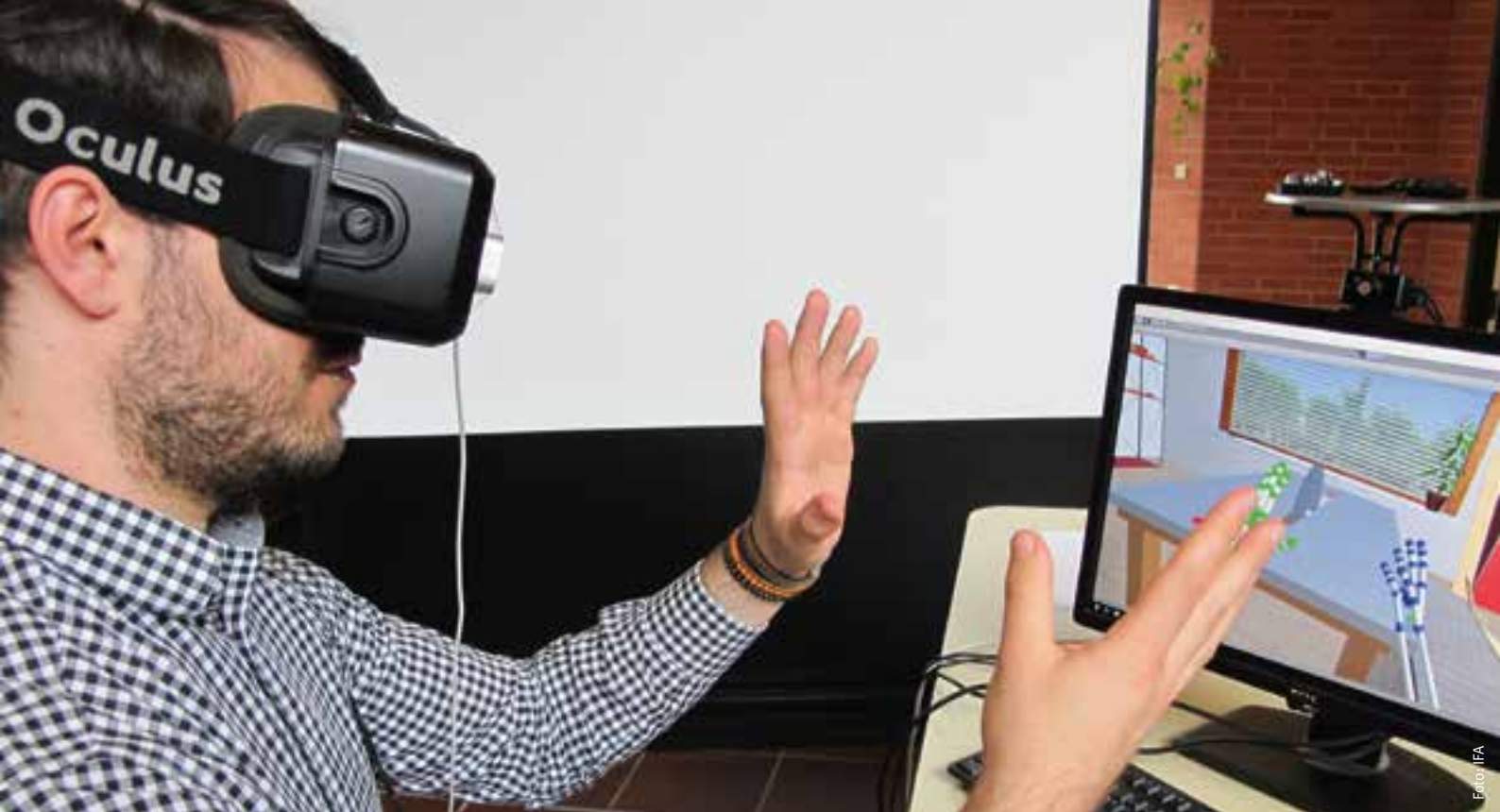
Abbildung 3: Binokulare geschlossene VR-Brille, Head-Mounted-Display (HMD)
