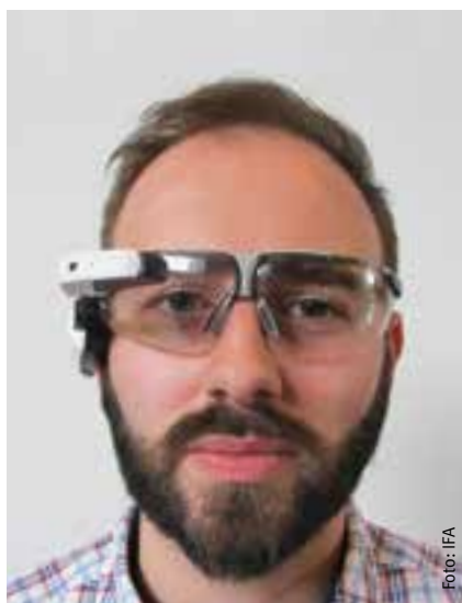
Abbildung 1: Monokulare geschlossene Datenbrille
