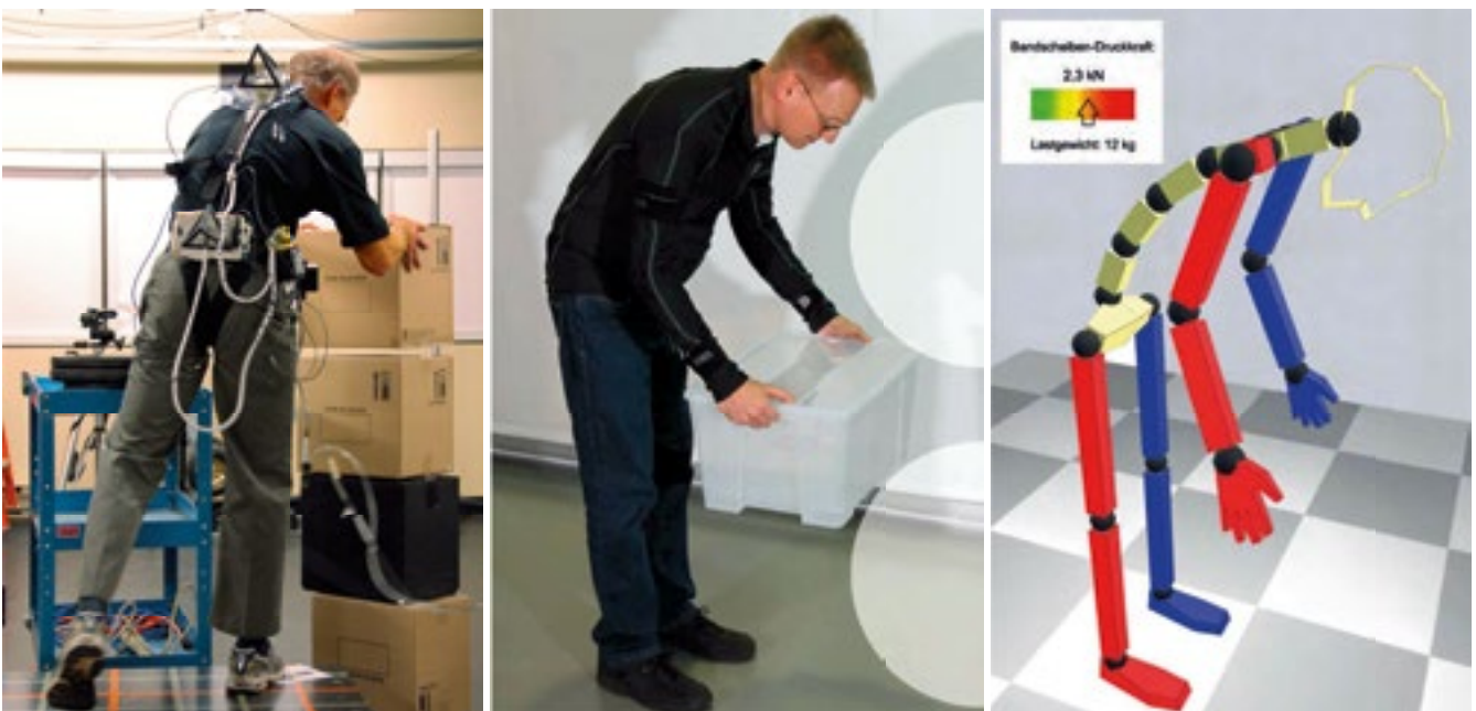
Abbildung 1: Internationale Kooperationen mit dem kanadischen IRSST zur Weiterentwicklung des CUELA-Messsystems: Prof. Plamondon trägt neue CUELA-3D-Inertialsensoren bei Validierungsversuchen im Labor des kanadischen IRSST (links). Der IFA-CUELA-Entwickler Hermanns testet die neuen Sensoren, die im CUELA-Rückenmonitor integriert sind (mitte). Eine zugehörige Online-Computerdarstellung zeigt die mittels biomechanischer Modellrechnungen bestimmte Bandscheibendruckkraft auf die unterste Bandscheibe L5/S1 (rechts).
