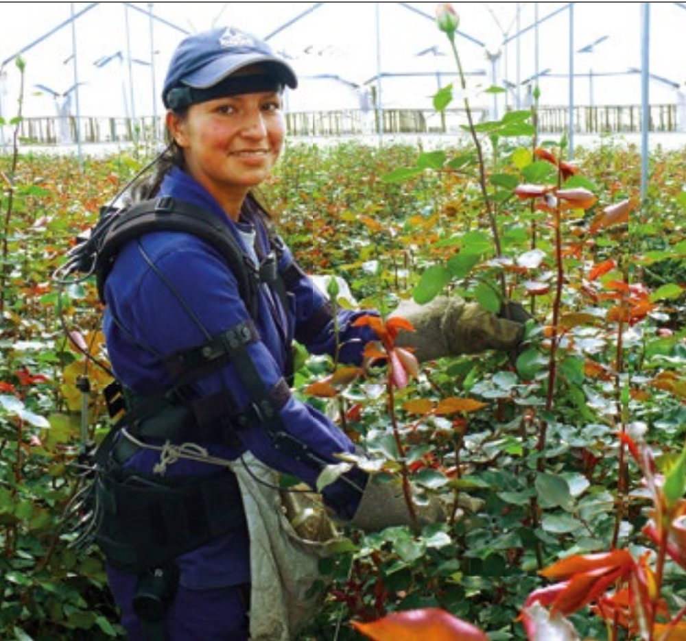
Abbildung 2: Beschäftigte mit CUELA-Messsystem bei der Tätigkeit des Rosenschneidens (links) und repetitive manuelle Arbeiten mit Beugung und Streckung der Handgelenke und Kraftaufwand in der kolumbianischen Blumenindustrie (rechts)
