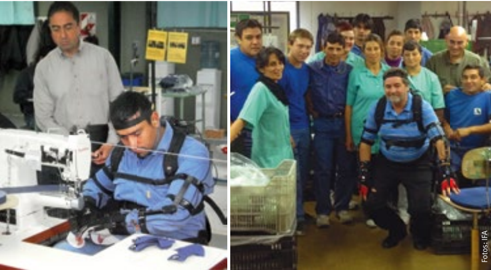
Abbildung 3: Einsatz des CUELA-Messsystems an Arbeitsplätzen in der argentinischen Nähindustrie
