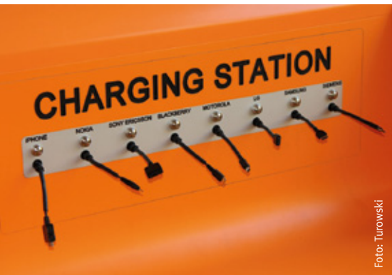
Eine Akkuladestation für Mobiltelefone – ohne Vereinheitlichung durch Normung. Die DIN EN 62684 soll dies ändern.
