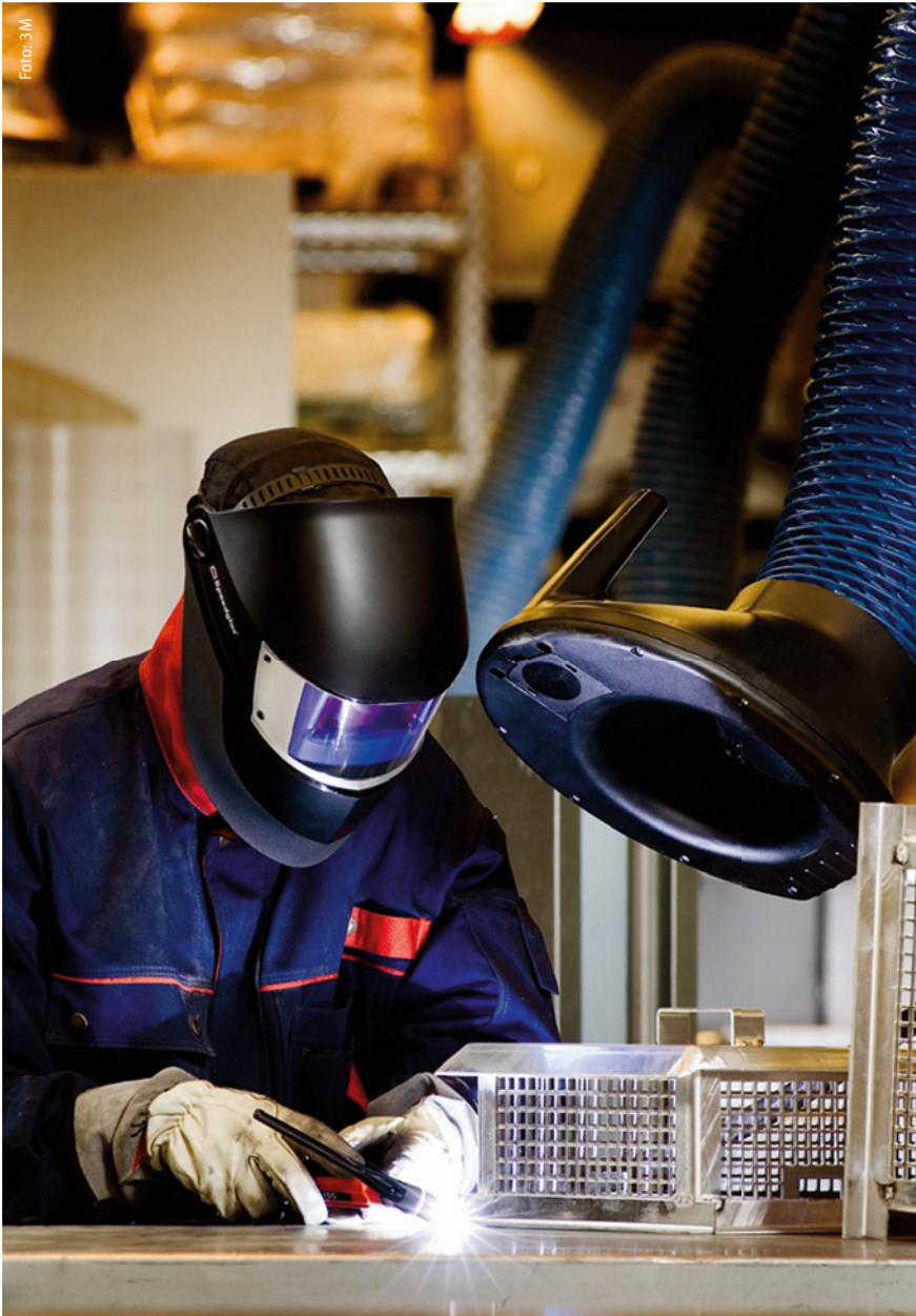
Abbildung 1: Gebläseunterstützte Helme beim Schweißen bieten optimalen Schutz.
