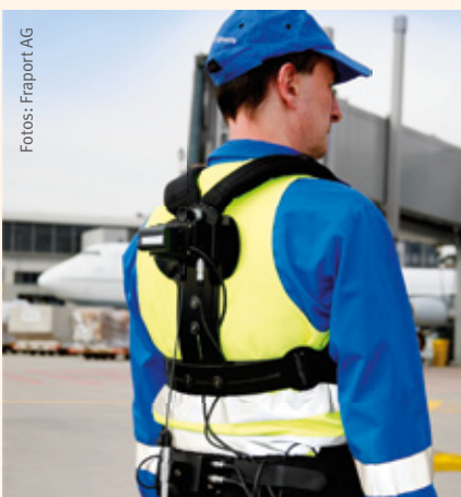
Abbildung 4: Mit dem CUELA-Messsystem werden Belastungen des Muskel-Skelett-Systems personenbezogen erfasst.
