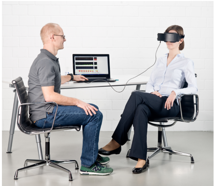
Die Pupillografie-Messung zeigt das Niveau der Schläfrigkeit
